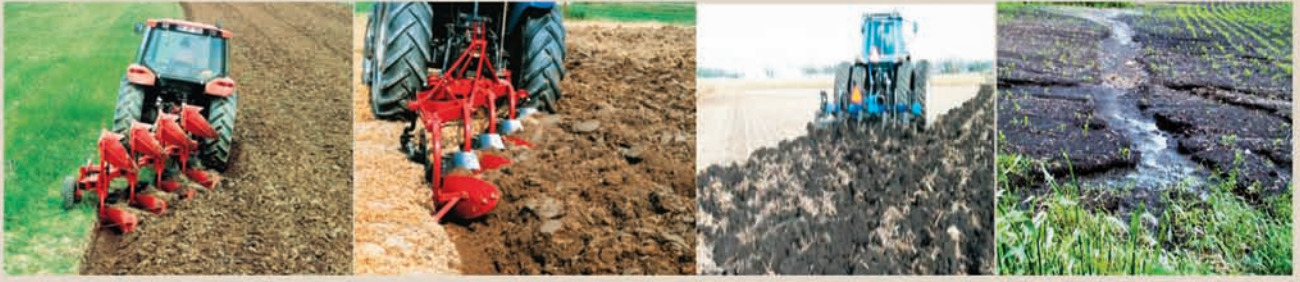
Şekil 2. Geleneksel yöntemde kullanılan kulaklı pulluk ve diskli pulluk
